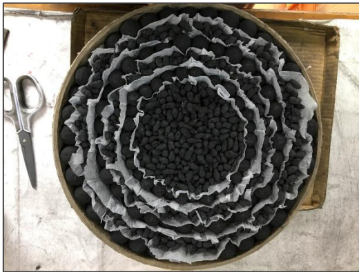
「割物」の花火玉（1尺玉）の断面図。
