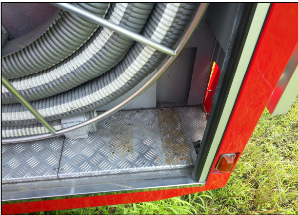
吸管ローラー取り外し状況
