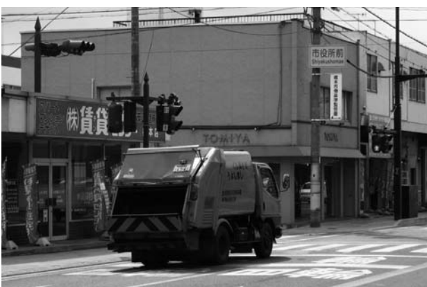
ごみ収集運搬を行うパッカー車
