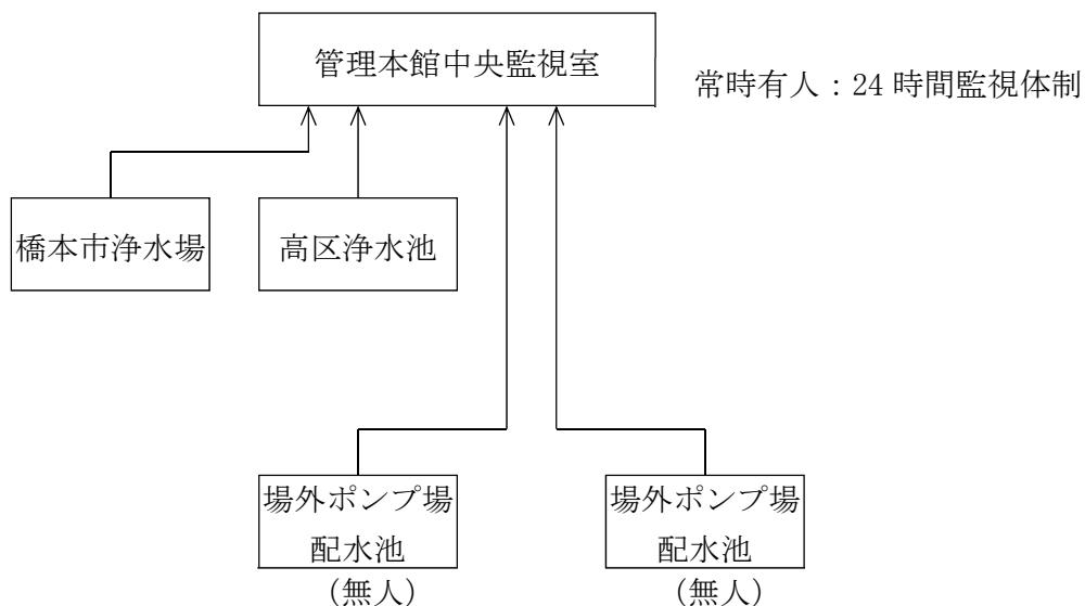
更新後の監視制御設備は、集中監視・分散制御方式とする。
